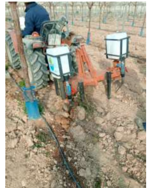
Foto 3 & 4: Due dosatori collegati a un distributore sotterraneo di concime minerali granulari
