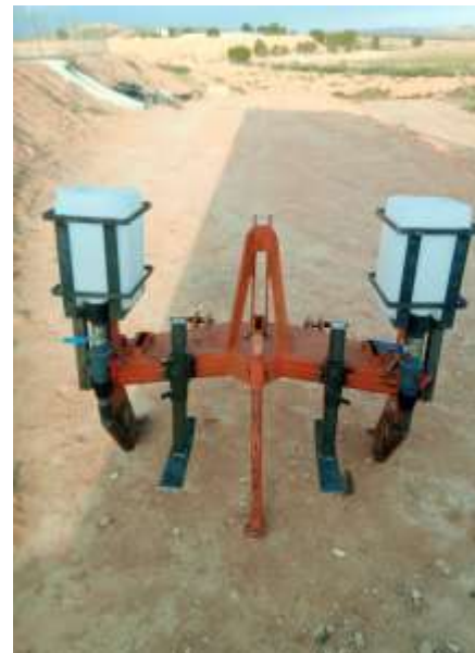
Foto 3 & 4: Due dosatori collegati a un distributore sotterraneo di concime minerali granulari
